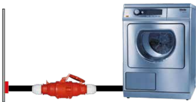
Anschluss über verschließbare Steckvorrichtungen
