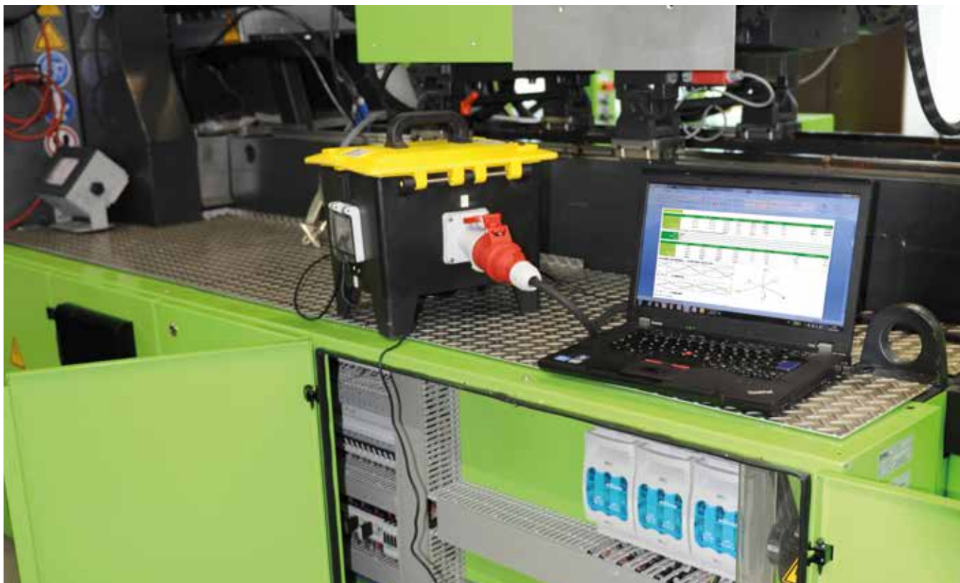
Messen über Maschinezuleitung mit Rogowski-Spulensatz
